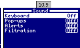
10.9 Lyd: Programmer systemet til at udsende lyd for funktionerne: Tastatur (taster); Notifikationer (pop-up-besked); Alarmer (arbejdsalarm); Filtrering (Start på filtrering).
